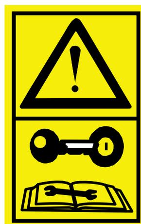
**Desligue a maquinaria e isole o fluxo de óleo auxiliar.**
